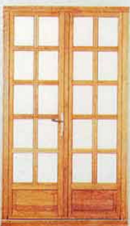
Porte-fenêtre chêne, petits bois véritables, panneaux massifs. (Poignée talon)
