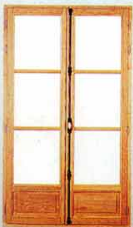
Porte-fenêtre chêne, petits bois collés, 2 faces, panneaux massifs. (Crémone en applique).
